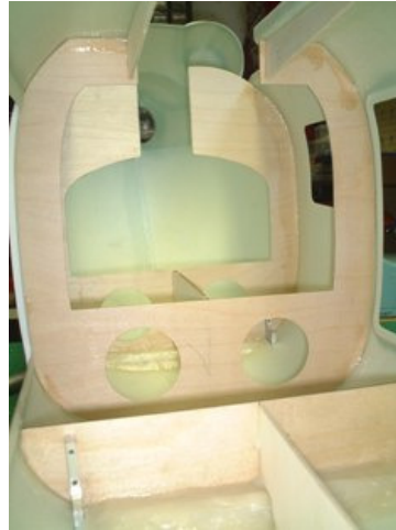
Die Spanten sind gesetzt
