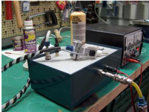
Nietenautomat , konstruiert von Kollege Pirmin
