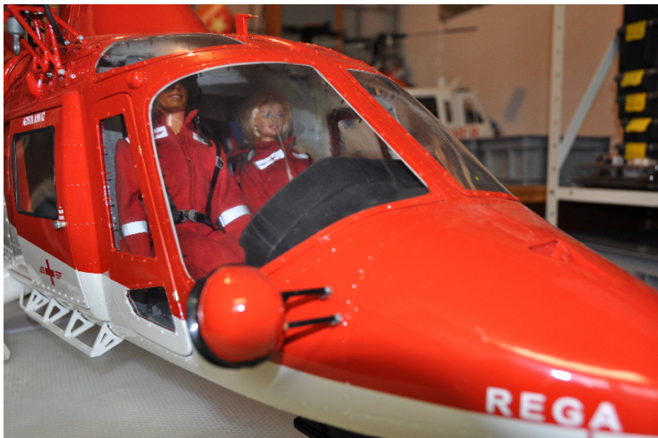
Die ganze Kanzel von vorn. Ebenfalls hat die Maschine ihre Beschriftungen erhalten und aus einem Kugelschreiber und ein wenig Hartlötarbeit ist das Pitotrohr entstanden.
