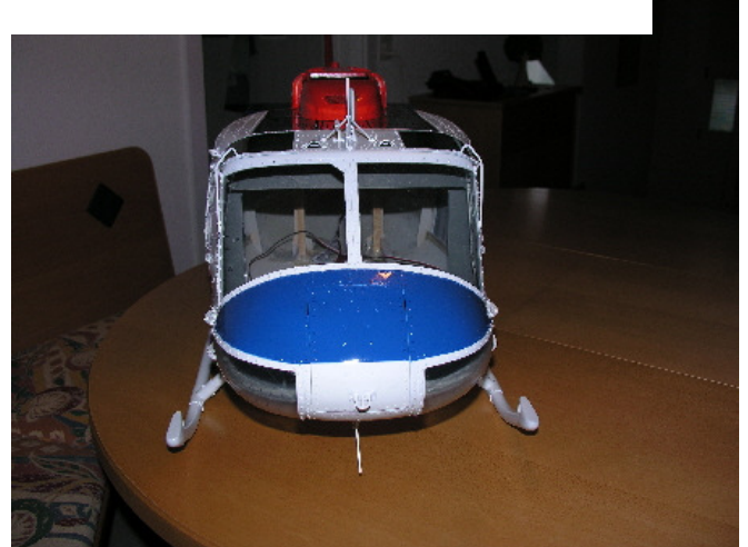
Ansicht von vorn: die Nase ist mit einem Servo aufklappbar
