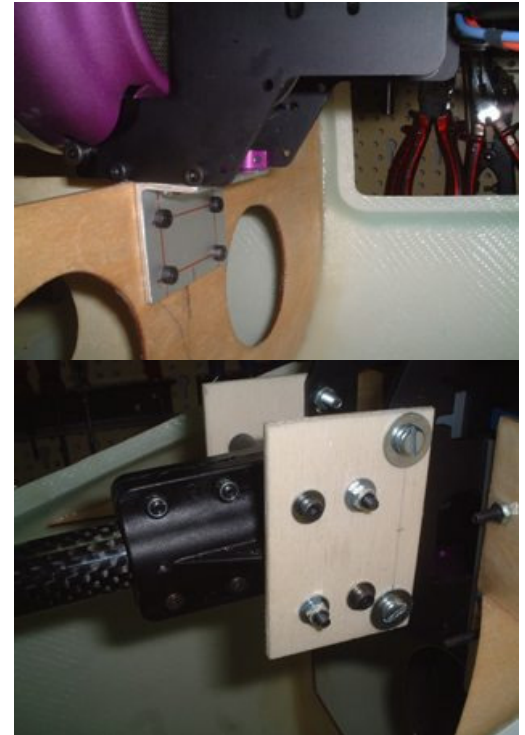
Die provisorische Heckverbindung
