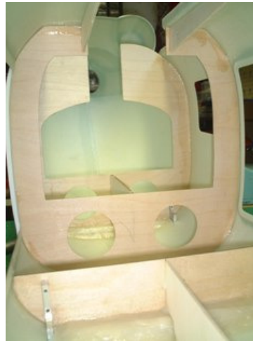
Die Spanten sind gesetzt
